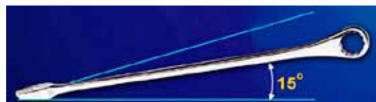
Designen med 15° lutning på nyckelns öppna ände ger ett bekvämt arbetsutrymme.
