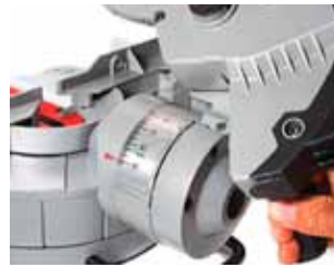
Lutningskapaciteten är -2° till 48°.
