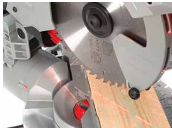
LED-ljuset lyser upp såglinjen bra i mörkare förhållanden.
