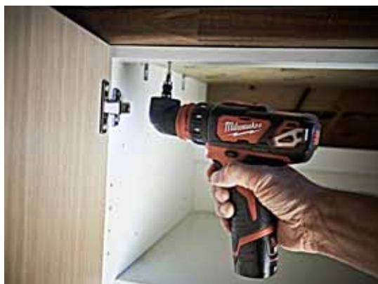
Vinkelchucken är suverän för att komma åt i trånga utrymmen.
