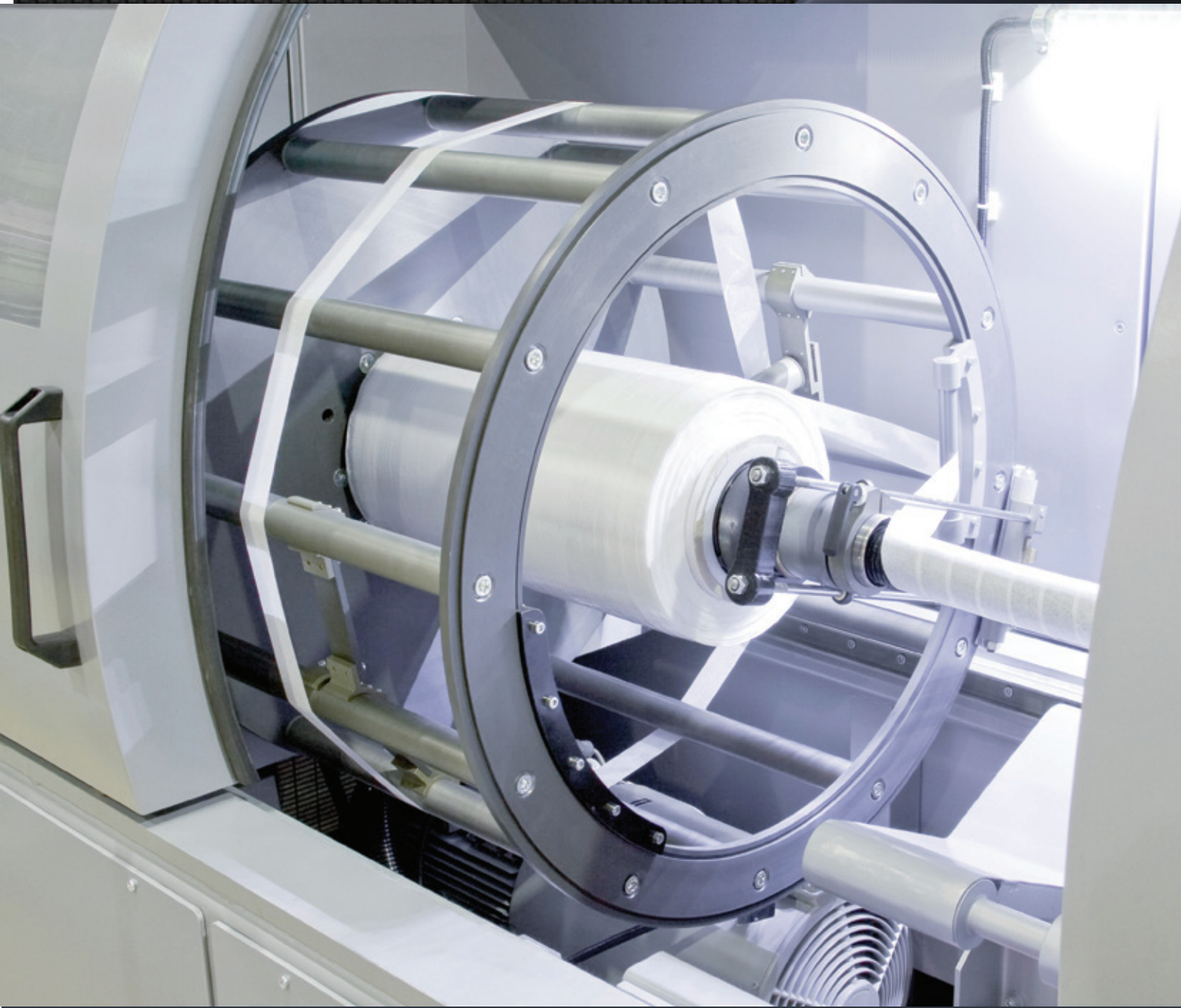
○ Rosendahl螺旋绕包机Rota 500
