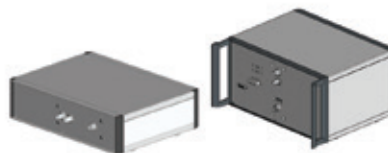
○ 图4: 电缆测试用瞬态记录器（左）和电缆监控仪（右）的3D模型
