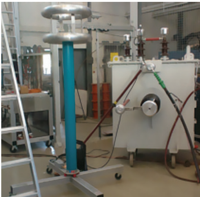
○ 图6: 交流电源和高压分压器
