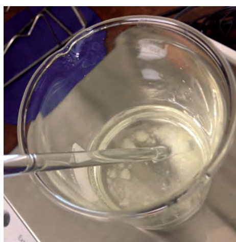
ABBILDUNG 5c: Lösen von Cannabidiol in Triglyceriden mit Hilfe eines Glasstabes
