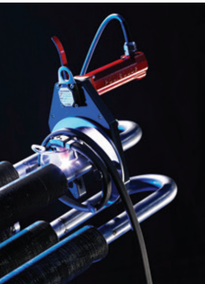
锅炉制造中使用“直管焊机”
