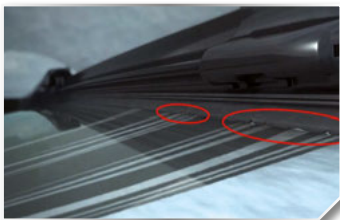
Cracked blade Poröses Wischgummi
