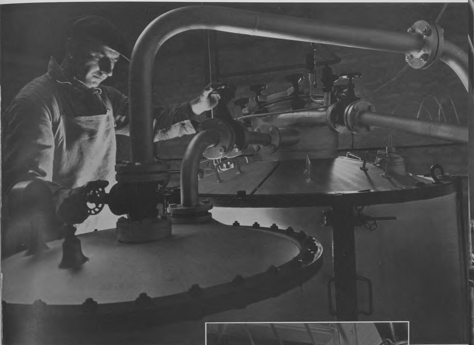
Kogning af Speciallakker.
