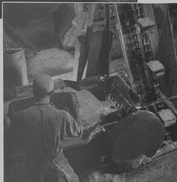
Sodaen knuses og transporteres til Afdrivningskarrene.
