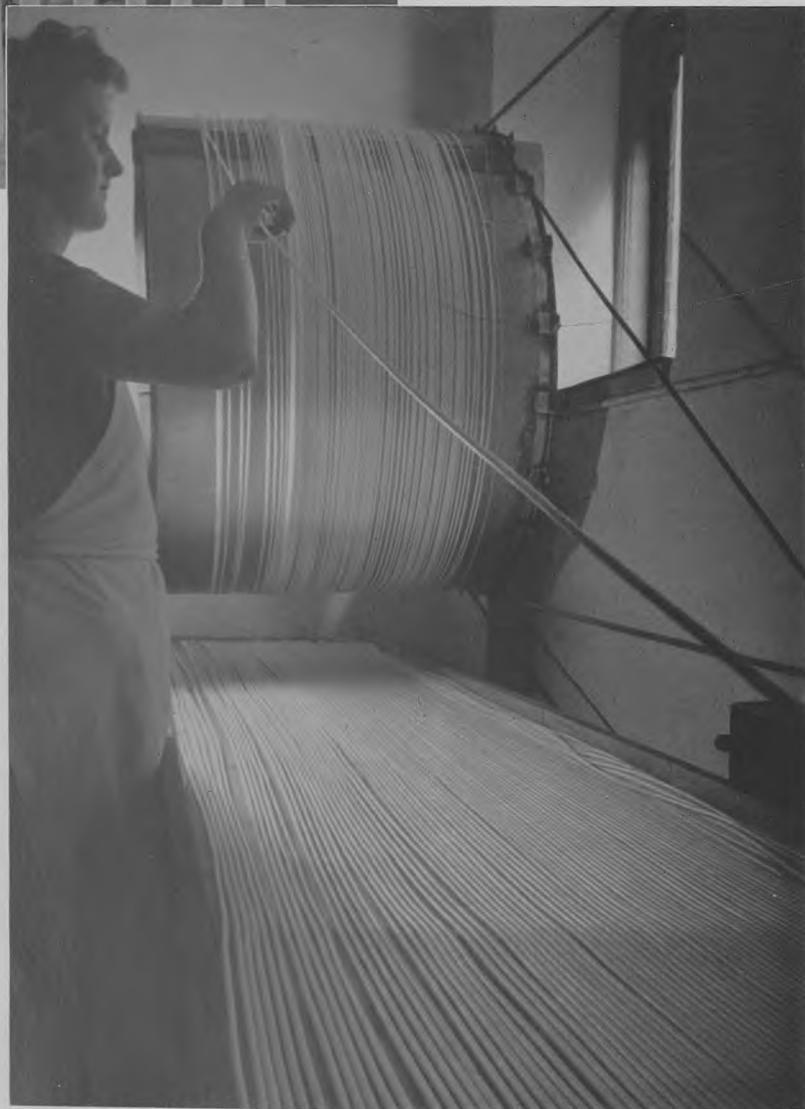
Dukkelys trækkes i 50 Meter lange Længder.
