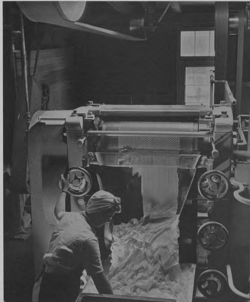
Paa vandafkølede Staalvalser fremstilles Asp Sæbespaner.
