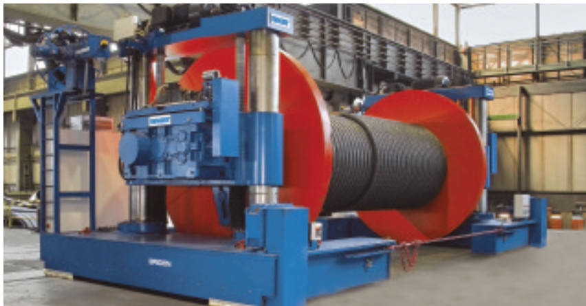
▲ Bei Bridon International im Einsatz stehender Aufwickler von SKET
