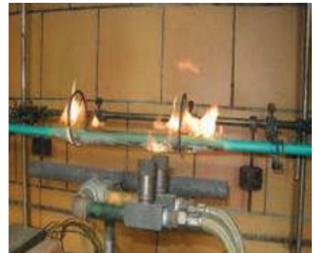
▲ Фото 3. Испытание на огнестойкость согласно стандарту EN 50200
