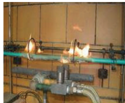
▲ Foto 3: Ensayo de resistencia al fuego IEC 50200
