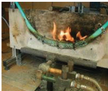
▲ Foto 2: Prova di resistenza al fuoco IEC 60331-25
