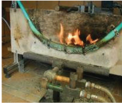
▲ Photo 2: Essai de résistance au feu IEC 60331-25
