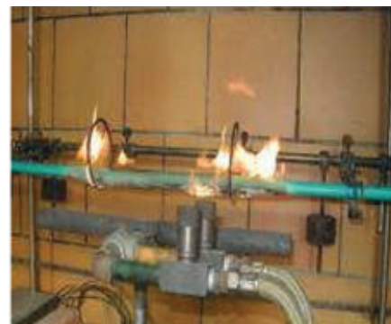
▲ Foto 3: Prova di resistenza al fuoco IEC 50200
