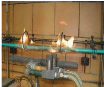
▲ Picture 3: EN 50200 fire test
