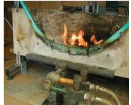
▲ Фото 2. Испытание на огнестойкость согласно стандарту МЭК 60331-25
