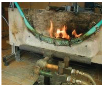
▲ Foto 2: Ensayo de resistencia al fuego IEC 60331-25
