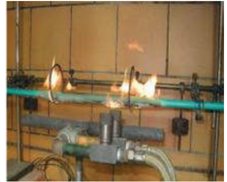
▲ Photo 3: Essai de résistance au feu IEC 50200
