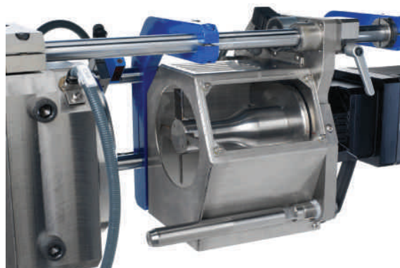
▲ Le nouveau malaxeur quantec de Buss incorpore un nouveau dispositif de coupe assurant des dimensions uniformes des pièces de PVC
