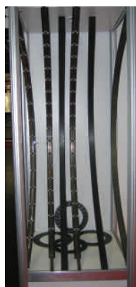
◀ Arcs pour rotors pivotants de ASEA produits en utilisant des fibres de carbone/aramide pure
