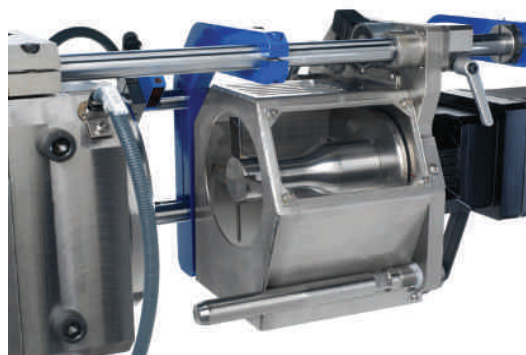
▲ Il nuovo impastatore quantec di Buss è equipaggiato con un nuovo dispositivo di taglio che assicura dimensioni uniformi dei pezzi di PVC
