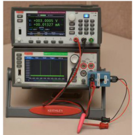
איור 1. מערך בדיקה של צריכת הזרם של התקן IoT אלחוטי, באמצעות ספק כח מדויק ורב-מודד סיפרתי דוגם גרפי
