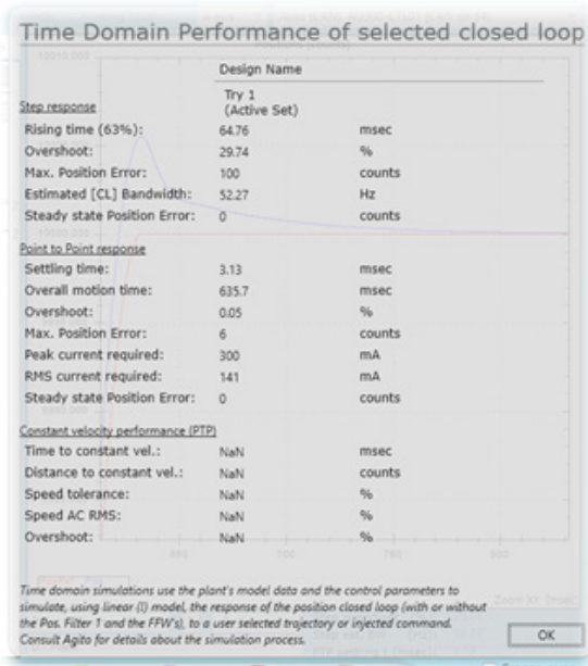
איור 13. תגובת Point To Point של המערכת (סימולציה) – זום על סוף התנועה
