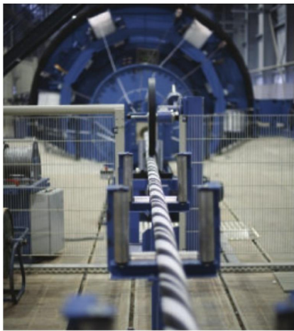
○ 世界上最大的电力电缆笼式绞缆机
