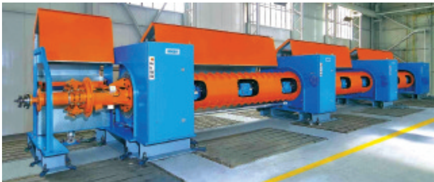
○ PTB-550高精度双捻机，带退扭 Cat. 5/6/7局域网电缆
