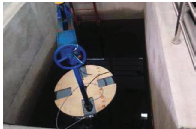
图1: 将带电缆的微管道浸入水中
