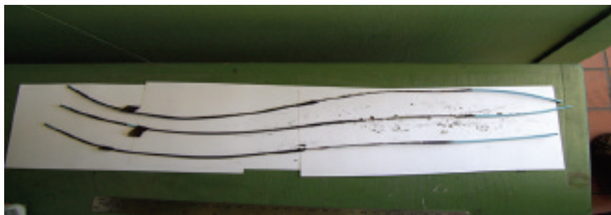
▲ Figura 6: Conservación de la lengüeta indicadora del alambre EL-1392B después de la prueba de inflamabilidad 1061
