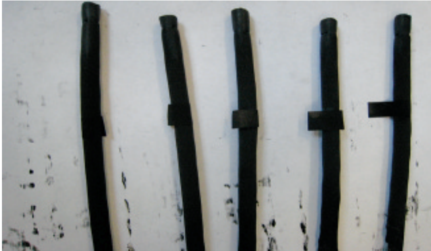
▲ Bild 7: Die Beibehaltung der Anzeigelehre von EL-1392B-Kabel bei 1061 Entflammbarkeitsprüfung für Kabel
