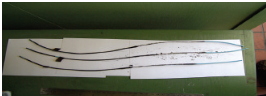
▲ Figure 6: Maintien de la languette d'indication d'un fil EL-1392B dans le test d'inflammabilité 1061
