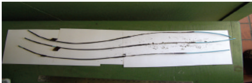
▲ Рис. 6. Сохранение флажкового индикатора на проводе из компаунда EL-1392B после испытания на распространение пламени согласно методике 1061
