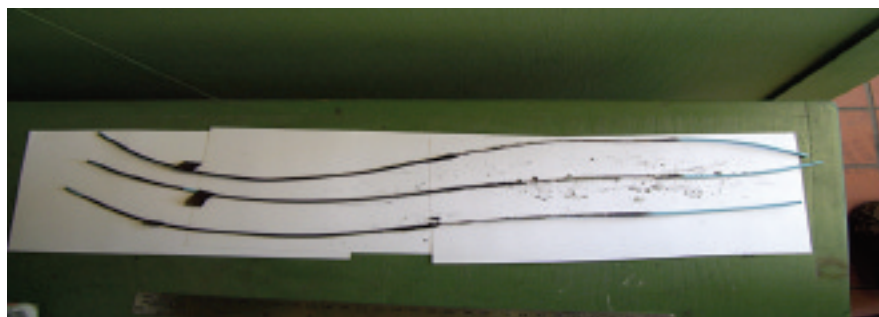
▲ Figura 6: Mantenimento della linguetta d'indicazione di un filo EL-1392B nel test d'infiammabilità 1061
