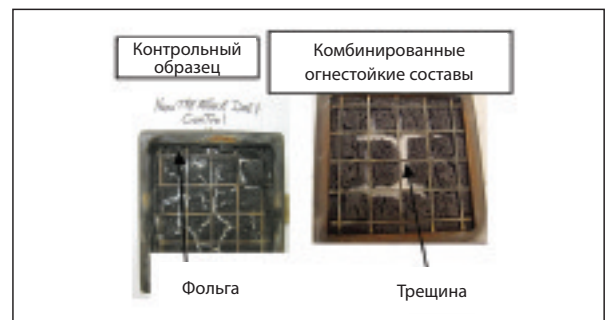
▲ Рис. 4. Коксообразование для обычных и комбинированных огнестойких составов
