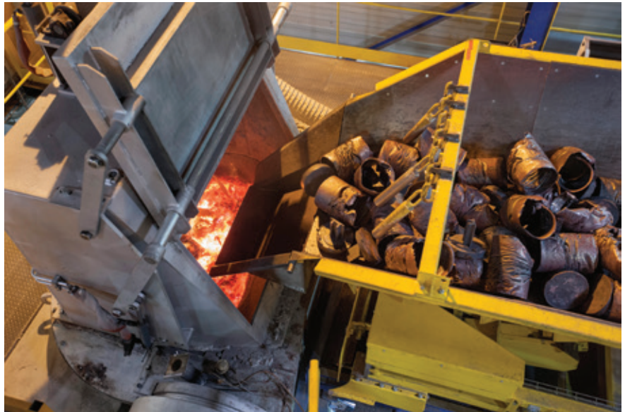
Upcast提供 OF 铜杆铸造工艺
