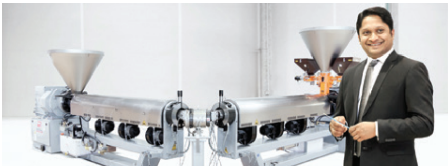
○ RosendahlNextrom 公司推出的太阳能电缆共挤工艺
