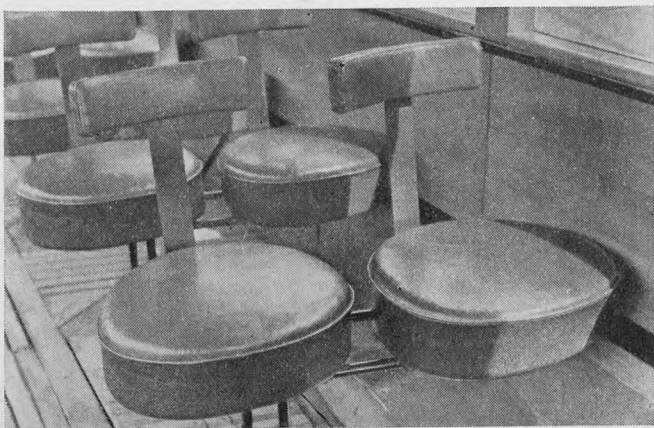
Nærbillede af Passagersæderne i Motorvogn Nr. 463. Det bemærkes, at de to Siddepladser er noget forskudt for hinanden, hvorefter det bliver lettere at komme forbi en Passager paa den yderste Siddeplads.
