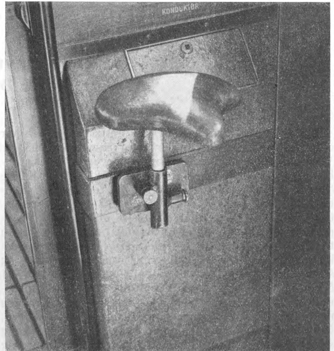
Det nye Konduktørsæde, som efterhaanden vil blive indført i samtlige Vogne. Sædet er indstilleligt i Højden.
