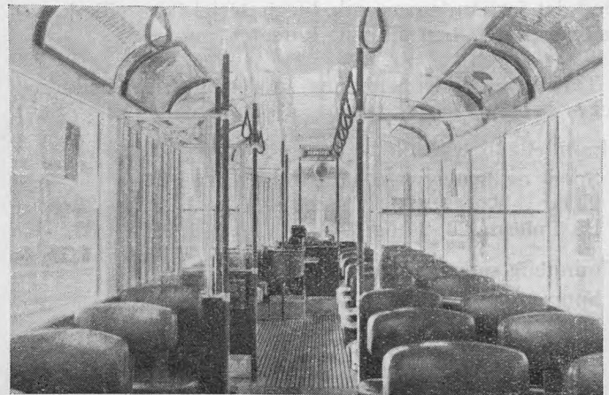
Det indre af prøvemotorvogn nr. 701. I baggrunden til venstre ses konduktørens faste plads, hvorfra billetteringen foregår.
