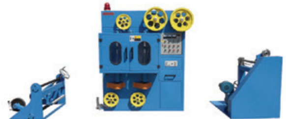
Taping machine(mica tape)
