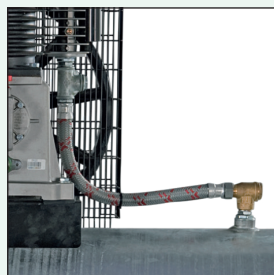
Furtun flexibil ranforsat, termorezistent, rezistent la vibrații.
