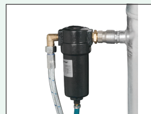
Microfiltru pentru colectarea condensului și a particulelor solide mai mari de 25 μm. Calitatea aerului comprimat conform ISO 8573-1. Utilizabil ca filtru preliminar în amonte de uscătorul de aer comprimat.
