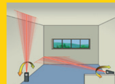
FONCTION TRACKING : Distance minimale ou maximale par balayage.
