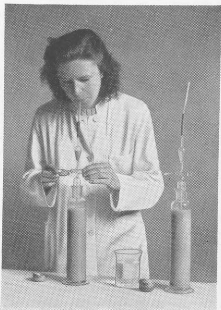
Undersøgelse af Cementers Finhed under Anvendelse af Sedimentation.
