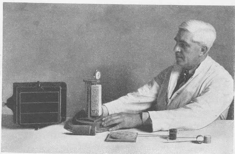
Prøvning af Cementers Rumfangsbestandighed ved Le Chateliers Kogeprovning af Cementkager samt Svind- eller Udvidelsesmaaling.
