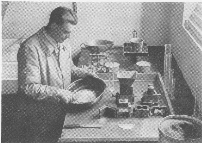
Fremstilling af Træk- og Trykprøvelegemer ved Prøvning af Cements Styrkeegenskaber.
