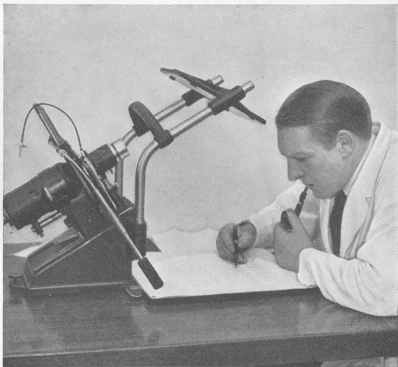
Spektrokemisk Analyse. Undersøgelse af Spektret i Maaleprojektoren.
