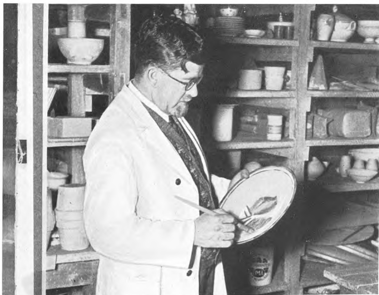
Fabrikmester O. Mathiesen udbedrer Glasuren paa en Stentøjsskaal
