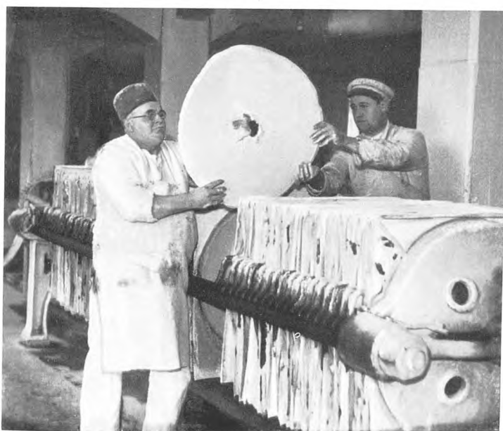
Filterpresserne i Slemmeriet
