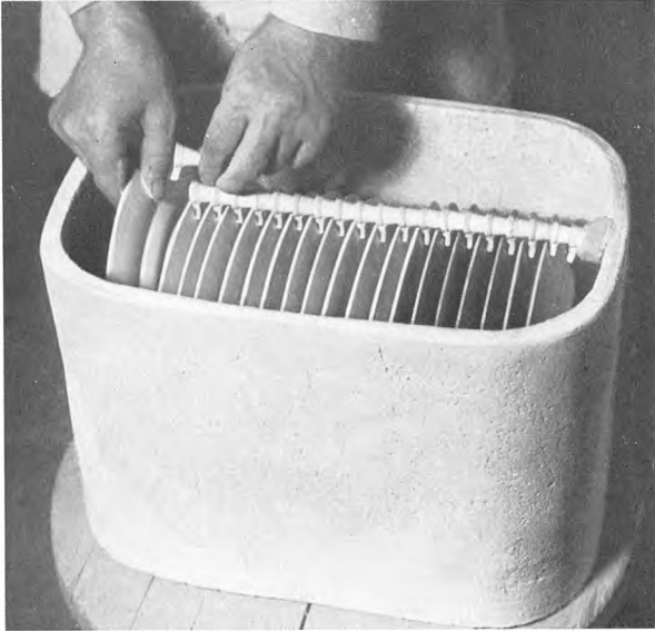
Fajancetallerkener sættes i Kapsel til Glatbrænding
