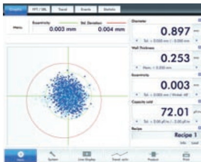
○ 云图显示偏心率分布单值（圆形分布）
