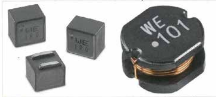
איור 6. חשוב מאד לחבר את הקצה המסומן בנקודה, סמוך למקור המיתוג.
