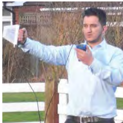
איור 2. חיבור אנטנה כיוונית ל-SNYPER (LiveScan) למציאת כיוון אופטימלי
