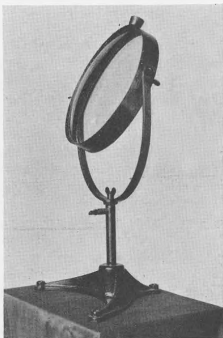
Fig. 2. Samleapparat til Sollysbehandling (buede Glasskiver adskilt af et Vandlag).
