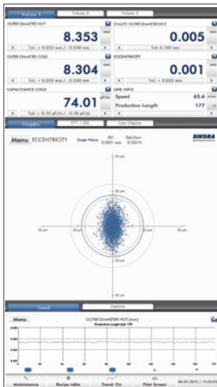
▲ Figura 5: Distribuzione di tipo ad ellisse dei singoli valori di eccentricità
