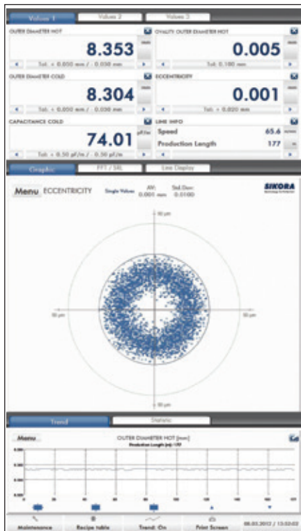
▲ Abb. 4: Ringförmige Verteilung der Einzelwerte der Exzentrizität
