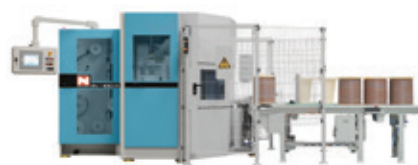
▲ Doppio avvolgitore tipo SV 400 D per fili isolati con bobine piene e vuote (sistema d'imballaggio Niehoff)
