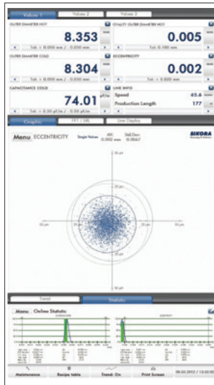
▲ Abb. 3: Zufällige Verteilung der Einzelwerte der Exzentrizität
