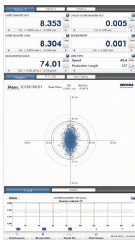
▲ Рисунок 5. Эллиптический тип распределения единичных показателей эксцентриситета
