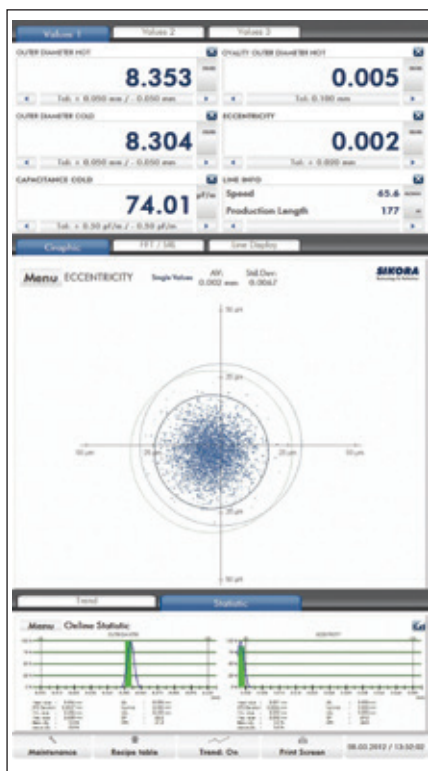
▲ Рисунок 3. Произвольный тип распределения единичных показателей эксцентриситета
