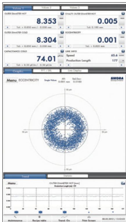
▲ Figura 4: Distribuzione di tipo ad anello dei singoli valori di eccentricità
