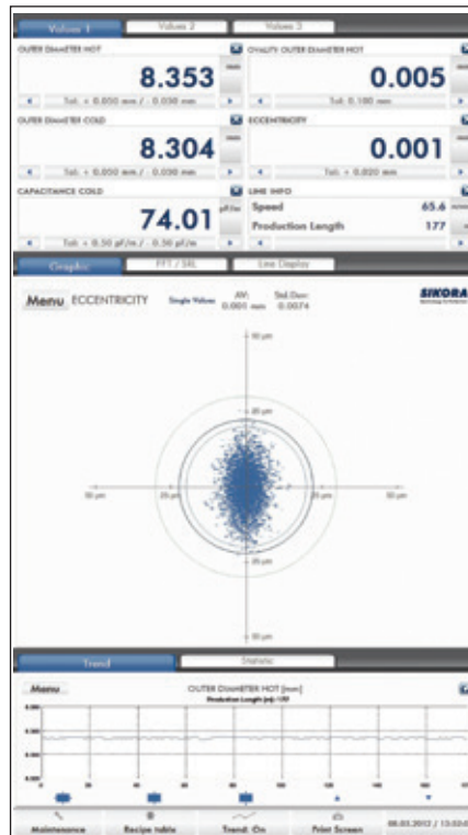
▲ Abb. 5: Ellipsenförmige Verteilung der Einzelwerte der Exzentrizität
