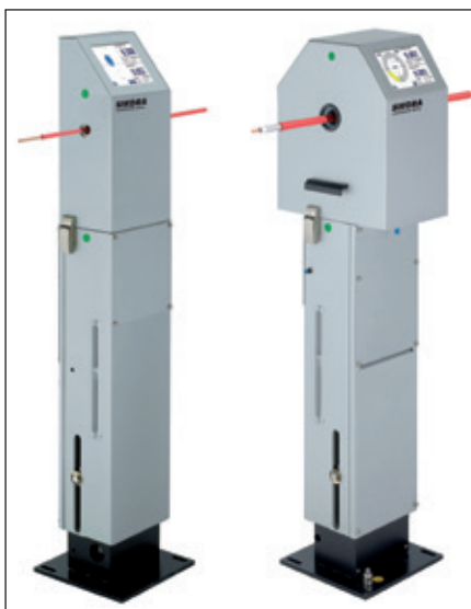
▼ Figura 1: Dispositivos para la medición de la concentricidad de un conductor en su aislamiento
