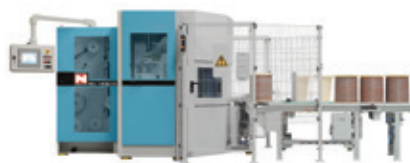
▲ Double enrouleur du type SV 400 D pour fils isolés avec bobines pleines et vides (système d'emballage Niehoff)
