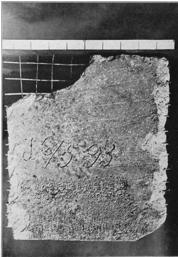
Jernbetonplade udsat for Havvand i 37 Aar.
