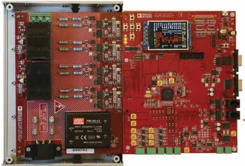
איור 4. ה-VDE-AR-N-4105 Technology Demonstrator מכיל שני ממסרים ראשיים מחוברים בטור היוצרים את נתיב ההספק הראשי ac, ושני ערוצי מדידת מתח מבודדים מדויקים ביותר המנטרים ביתירות את מתח ac הראשי, ועוד מתחי מוצא המהפך PV ומתחים בין-ממסרים במערכת בעלת מופע יחיד.
