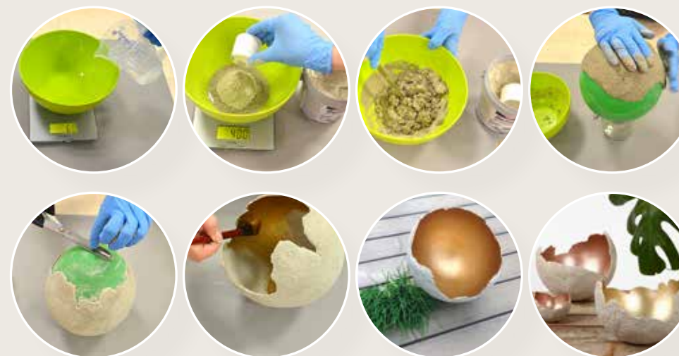
Voor het maken van een schaal wordt de betonpasta over een ballon gesmeerd. Na het drogen kan de ballon verwijderd worden.
