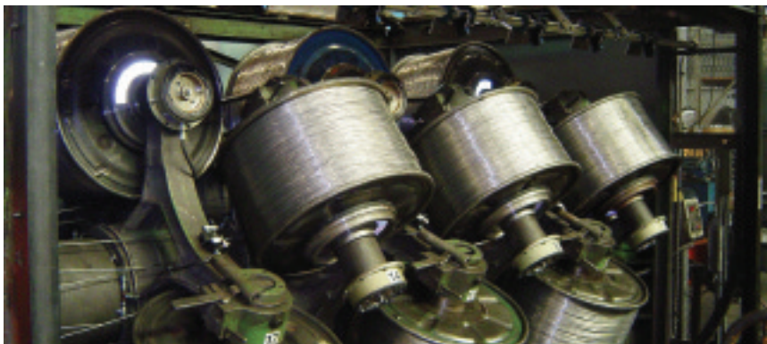
○ 线材断裂检测检测器的典型布置
