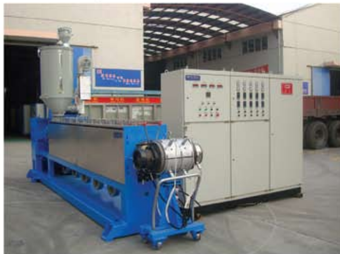
HD-160/200+120 高压共挤护套电缆包覆机组 HD-160/200+120 Sheathing cable extruder line
