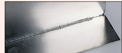
Sudură pe aluminiu cu WIG AC
