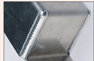
Sudură pe oțel Cr-Ni cu WIG
