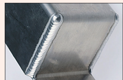
Sudură pe oțel Cr-Ni cu WIG
