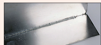
Sudură pe aluminiu cu WIG AC
