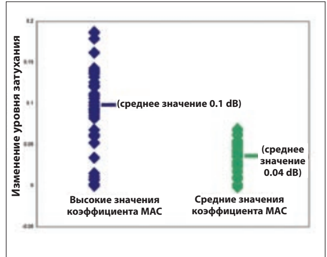
▲ Рис. 5. Изменение уровня затухания в оптических волокнах с высоким и средним коэффициентами MAC
