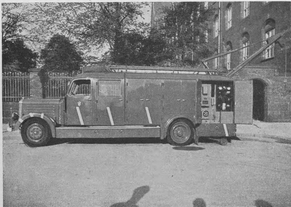
Ingeniørtenderen med Kranen udlagt.
