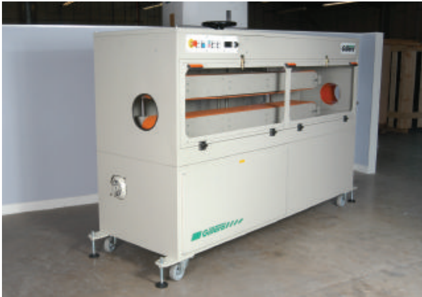
▲ La nuova macchina di Gillard è equipaggiata con cinghie più lunghe per esercitare una minore pressione sui prodotti estrusi
