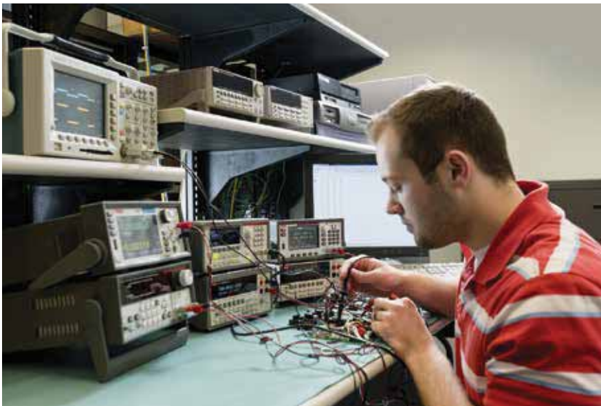
« איור 2. אפיון Benchtop של התקנים אלחוטיים בעלי צריכת חשמל נמוכה דורש מכשור המשלב את הרגישות הדרושה לצורך מדידת זרמי רוגע עם המהירות הדרושה ללכידת פולסי זרם צרים, כמו גם תחום רחב של מקור אספקת הזרם
