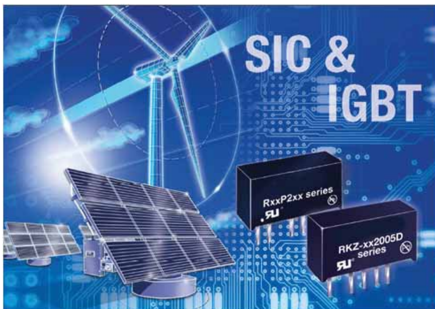
« איור 1: ממירי זרם ישראל/זרם ישיר עם בידוד רב מבטיחים הזנה מיטבית למנהלי התקן SiC-FET ו-IGBT באלקטרוניקת ההספק
