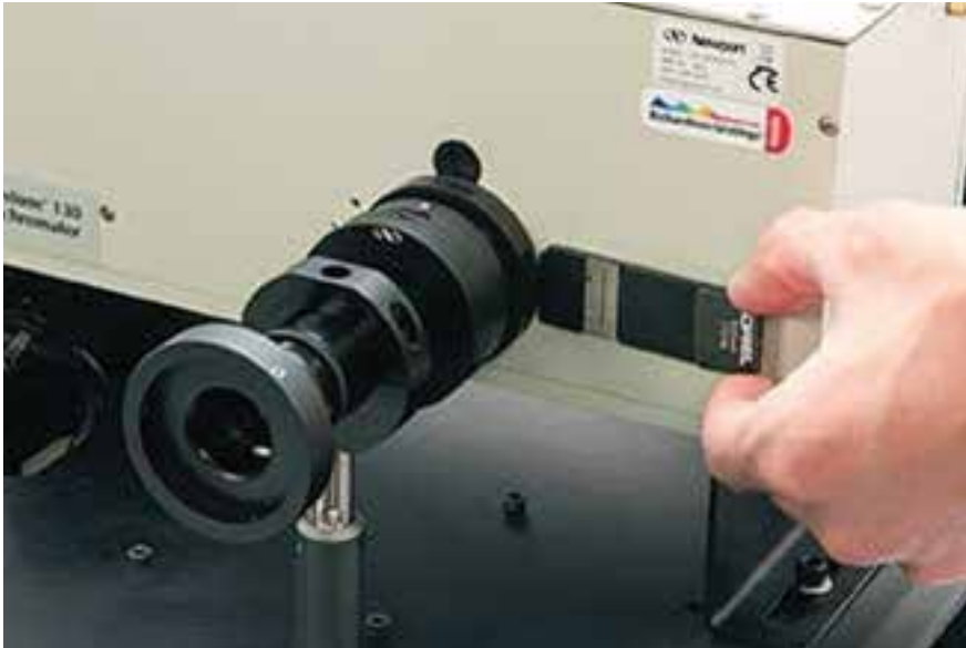
» אור 4. חריץ בעל רוחב קבוע מותקן לתוך מונוכרומטור Newport Corp. התמונה באדיבות של Oriel.
