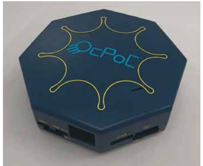
» איור 2. המערכת OcPoC תהיה פלטפורמת בקרת הטיסה, הראשונה הזמינה מבחינה מסחרית, שמופעלת באמצעות המערכת על שבב Zynq
