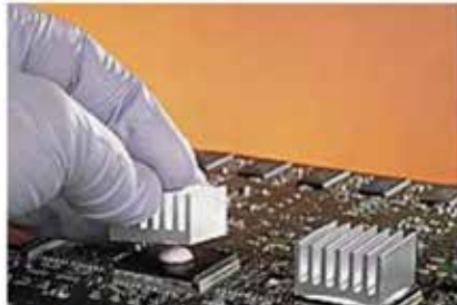
איור 5. דוגמה ליישום של דבק מוליך חום בתווך שבין CPU ל-HEAT SINK
