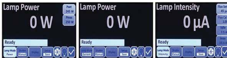
» איור 3. ספקי הכוח מסדרת OPS של Oriel מציעים את האפשרות להפעלת נורה במצבי פעולה בהספק קבוע, זרם קבוע או עוצמה. התמונה באדיבות Newport Corp
