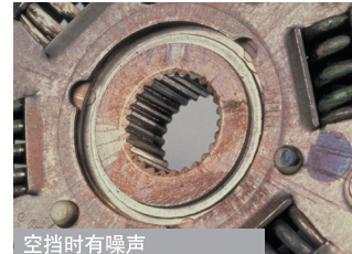
空挡时有噪声 Noise when in Neutral
