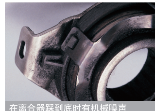
在离合器踩到底时有机械噪声 Metallic Noises at Bottom of Pedal Travel
