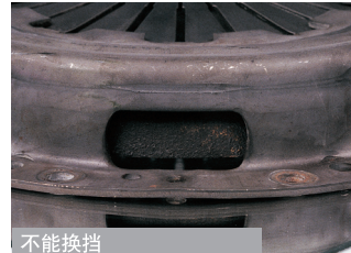
不能换挡 Impossible of Change Gear
