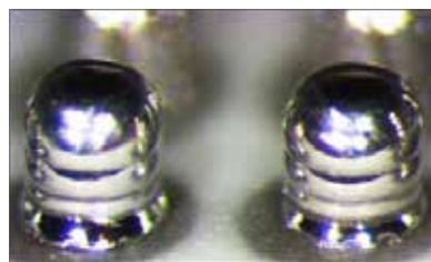
איור 4. מגדל כדוריות בדיל בשיטת Solder Stacking
