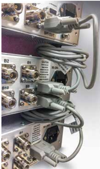
איור 5. שלוש יחידות מחוברות בשרשרת דיגיטלית דרך ממשקי SPI בלוח החיבורים האחורי
