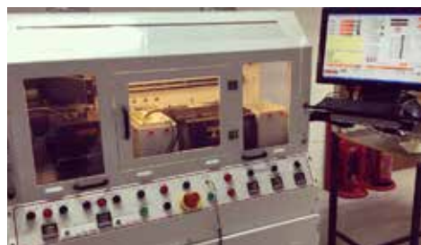
איור 3. מערכת להסרת ציפוי בדיל נטול עופרת (Lead-Free) והמרה וציפוי בבדיל-עופרת
