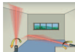
FUNCIÓN DE REPLANTEO DE DISTANCIAS CONSTANTES: Minimum or maximum distance per scanning FUNÇÃO DE REMODELAÇÃO DE DISTANCIAS CONSTANTES: distância mínima ou máxima por medição
