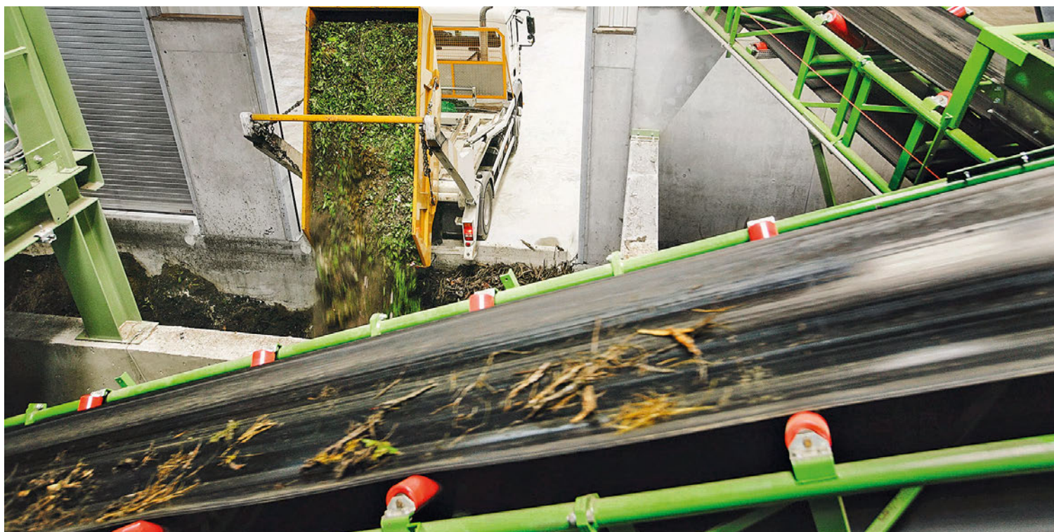
Der gesammelte Bioabfall wird auf eine Korngrösse von maximal 6 cm zerkleinert und dem Biogasfermenter zugeführt. Dort findet die industrielle Umwandlung von unverholzter Biomasse in Biogas statt.
