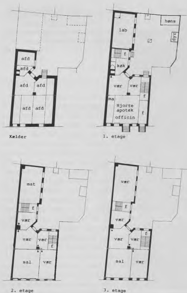
Fig. 4. Skematisk rekonstruktion af etageplaner 1:500 af matr.nr. 336B, Købmager Kvarter, som det så ud ved opførelsen 1801-1802 (Kirsten Lindberg).
