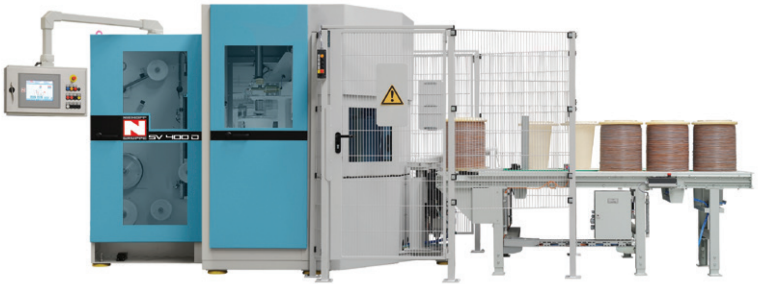
○ SV 400 D型双转子收线机，适用于绝缘导线，线轴可满载或空载（Niehoff包装系统）
