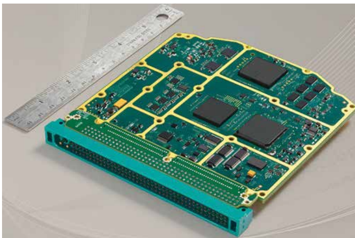
איור 8. מקלט GPS מסוג M-CODE המגן מחסימות עוינות
