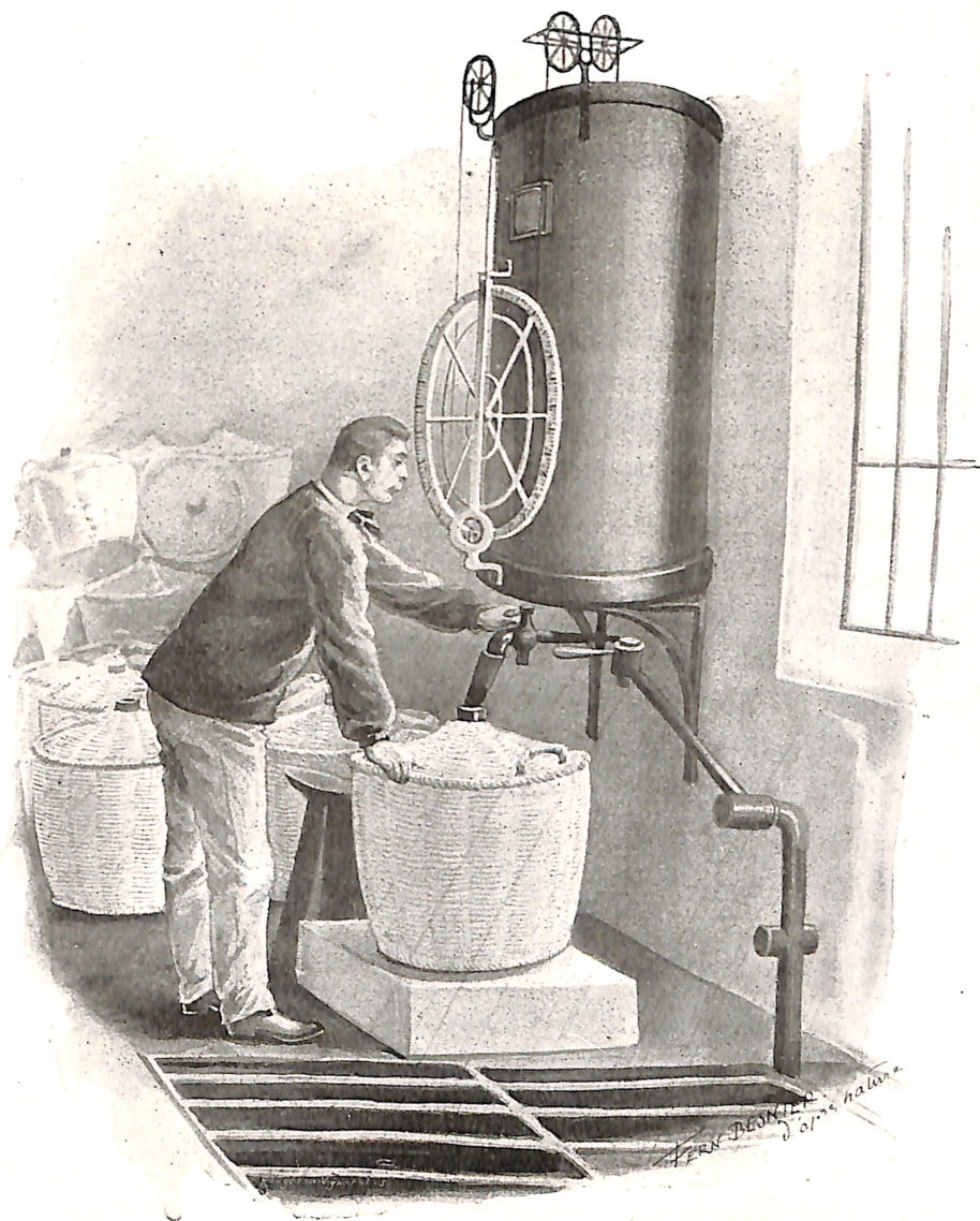
Appareil à jauger la contenance des futailles et des bonbonnes.
