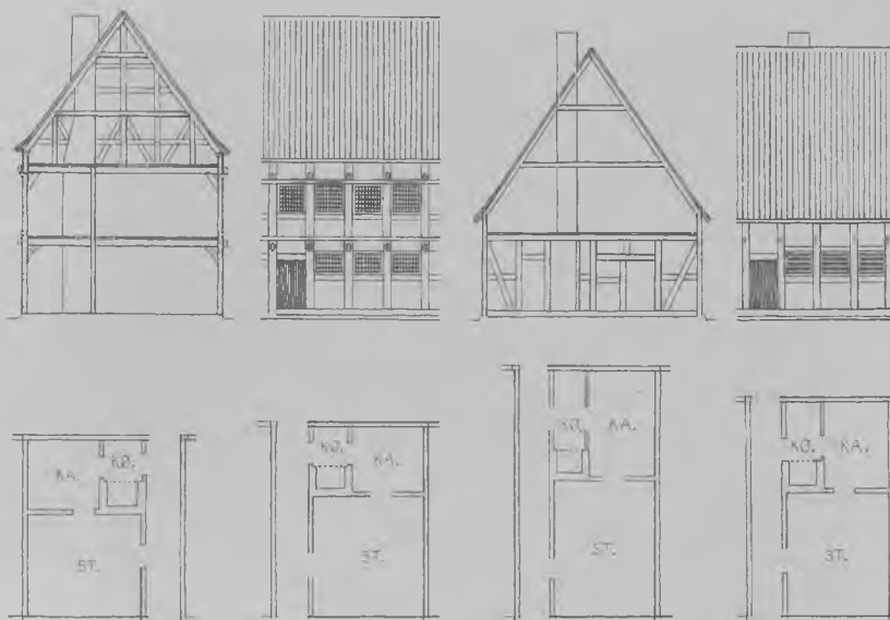
Københavnske lejevåninger fra første halvdel af 1600-årene. Planerne viser (fra venstre til højre) Holmensgade 7, 48 Sct. Annægade 25, 53 Overgaden oven Vandet 16 51 og Sct. Annægade 14. 47 Snit og gadeside t. venstre er fra Sct. Annægade 25 og t. højre fra Sct. Annægade 14. Alle tegningerne er gengivet i mål 1:300.
