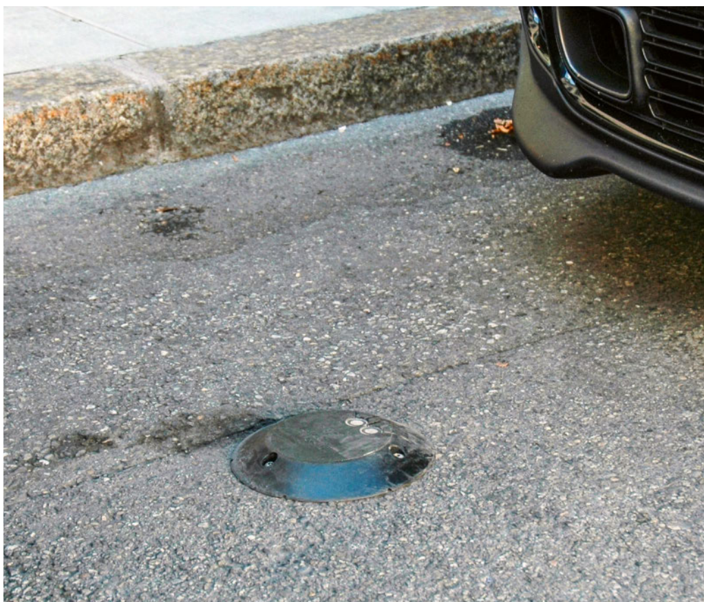
Les capteurs, installés à différents emplacements et hauteurs, permettent une détection électromagnétique et une autre ultrasonique.
