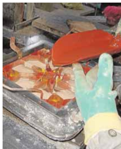
A la izquierda, Marta Martínez, ante algunas de las muestras de las baldosas hidráulicas. Sobre estas líneas, el momento de la fabricación en el que se vierte el color sobre la trepa. Abajo, una vez que la pieza se saca del molde en el que se ha metido en la prensa se deja secar algunas semanas.
