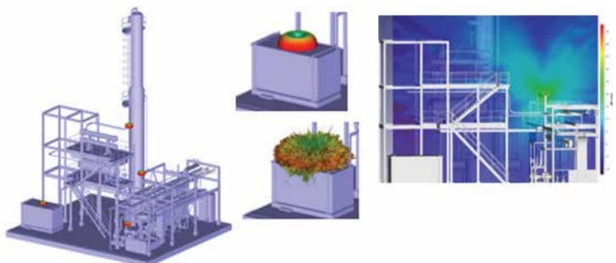
» איור 6 - דפוס הקרינה האידיאלי בצורת סופגנייה של חיישן מופר בסביבה תעשייתית בשל מבנים מוכן לאנטנה. סימולציה יכולה לזהות ולמתן בעיות אלה. באדיבות ESSS
