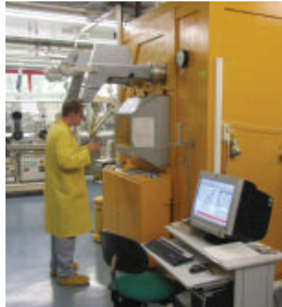
▲ Operador que usa el probador de indentación en la celda caliente
