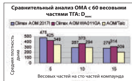
▲ Рис. 8. Максимальная плотность дыма для Ketgard STA и промышленно выпускаемого OMA
