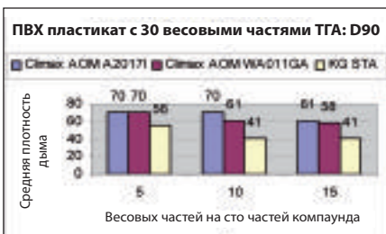
▲ Рис. 3. Плотность дыма по методу НБС для Ketgard STA и промышленно выпускаемого OMA с интервалом в сто частей компаунда
