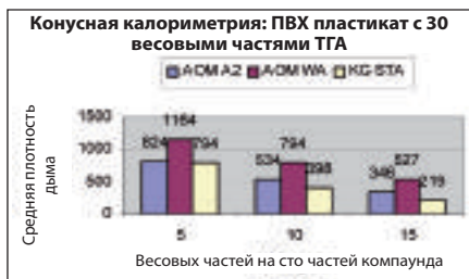
▲ Рис. 9. Общий уровень задымления для Kemgard STA и промышленно выпускаемого OMA при внесении 30 весовых частей ТГА и тепловом излучении 70 кВт/м 2
