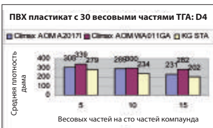
▲ Рис. 4. Плотность дыма по методу НБС для Ketgard STA и промышленно выпускаемого OMA с интервалом в четыре минуты
