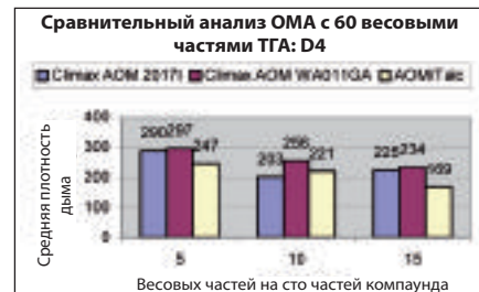
▲ Рис. 7. Плотность дыма по методу НБС для Ketgard STA и промышленно выпускаемого OMA с интервалом в четыре минуты
