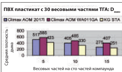
▲ Рис. 5. Максимальная плотность дыма для Ketgard STA и промышленно выпускаемого OMA
