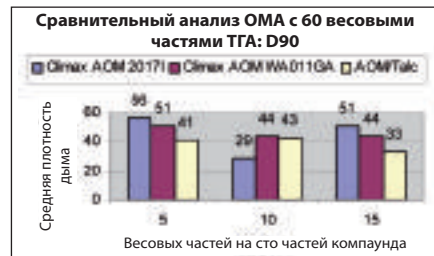
▲ Рис. 6. Плотность дыма по методу НБС для Ketgard STA и промышленно выпускаемого OMA с интервалом в девяносто секунд
