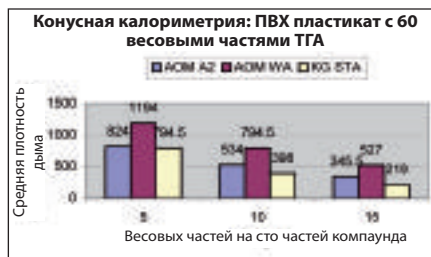
▲ Рис. 10. Общий уровень задымления для Kemgard STA и промышленно выпускаемого OMA при внесении 60 весовых частей ТГА и тепловом излучении 70 кВт/м 2
