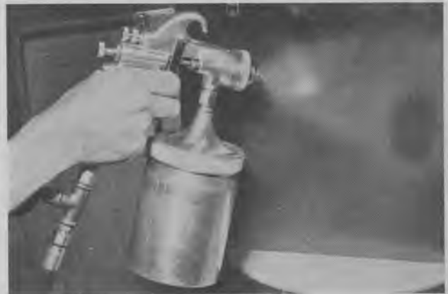
Fig. 615. Sugefødning. Ved 3½ atm. tryk suges der ca. 175 cm 3 lak frem pr. minut, når man som her anvender en 1,75 mm dyse, og lakkens viskositet er 25 sek.
