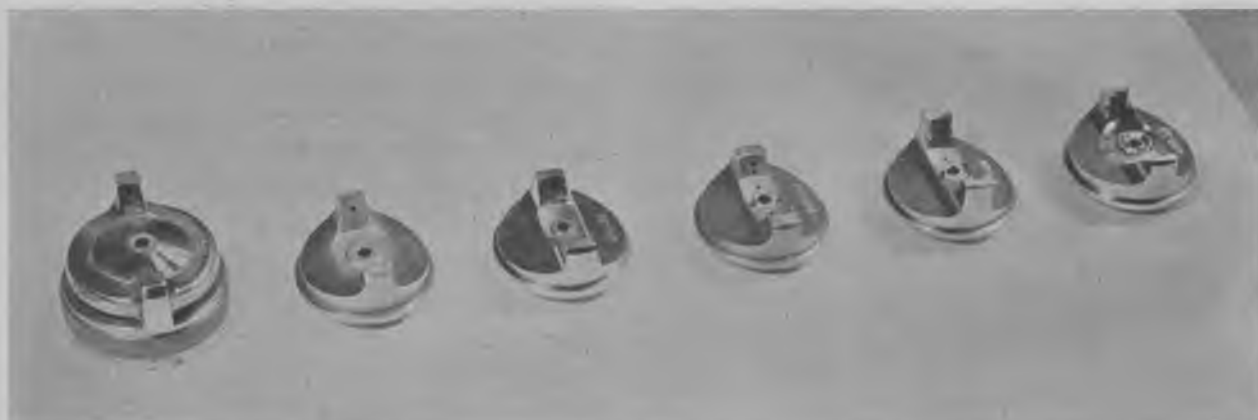
Fig. 618. En række af de mest anvendte luftmundstykker. Det længst til venstre er et sugefødemundestykke. Nr. 2 fra venstre er meget luftbesparende. Nr. 4 bruges fortrinsvis til varmsprøjtning af cellulose. Nr. 5 og 6 er til meget fin forstøvning af store lakmængder.
