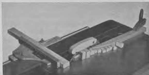
Fig. 113. Når man anvender en afviserliste, kan bagtænderne ikke få fat i træstumperne.
