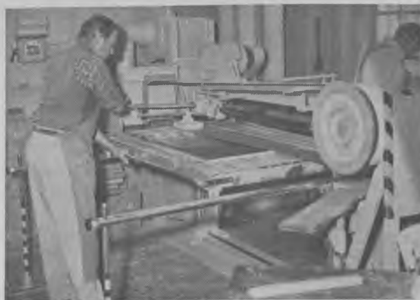
Fig. 631. Tørslibning af syrehærdende lakker på båndpudser med en båndhastighed på 20–22 meter pr. sekund.
