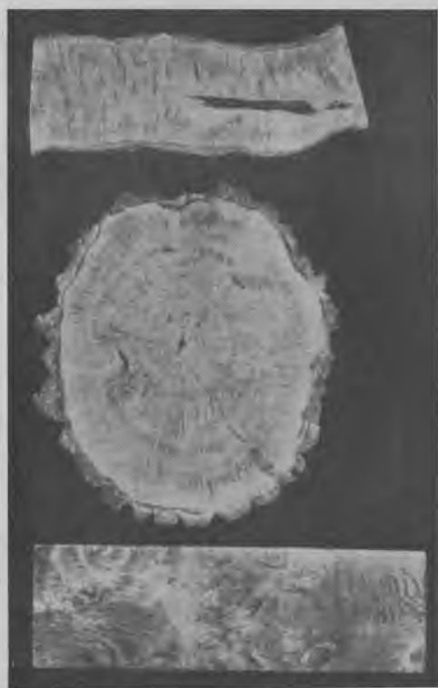
Fig. 9. Oppe fra og ned: længdesnit gennem birk, tværsnit gennem birk og længdesnit gennem fyr med vredet og bølgeformet årringer, masret vækst.
