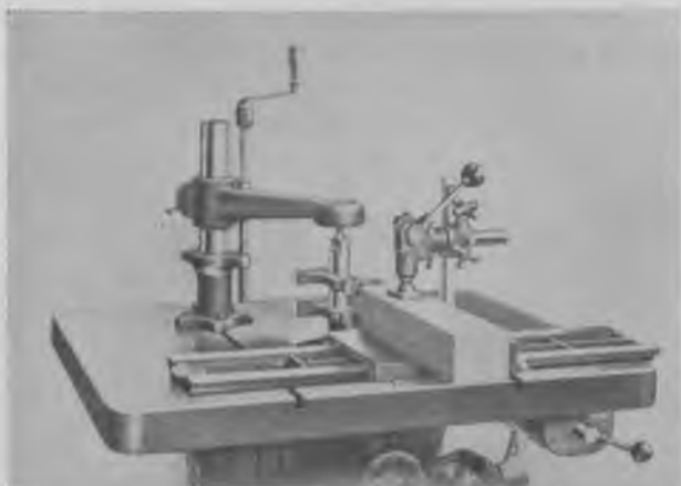
Fig. 247. Tapslæde til fræser. Spindelen er forsynet med pinolstyr, hvilket er nødvendigt på grund af de højt anbragte jern.
