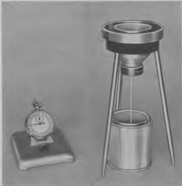
Fig. 614. Måling af viskositeten med Ford Cup 4. Den tid, som de 100 cm 3 lak – som ford-cup'en indeholder – er om at løbe ud gennem det 4 mm store hul i bunden, er udtryk for lakkens viskositet, her f. eks. 22,5 sek.
