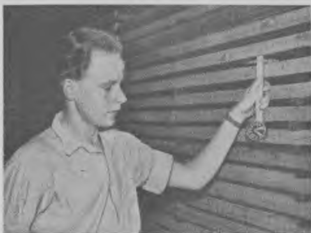
Fig. 72. Måling af lufthastighed.
