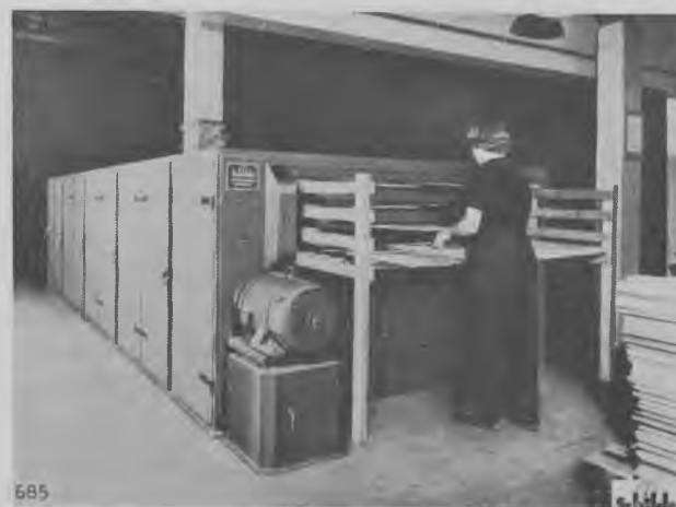
Fig. 95. Mindre tørreovn for finér (Benno Schilde).
