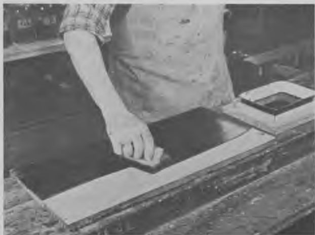
Fig. 601. Det er både hurtigt og nemt at påføre bejdse med en plydsklods, og den stænker ikke så let som en pensel.
