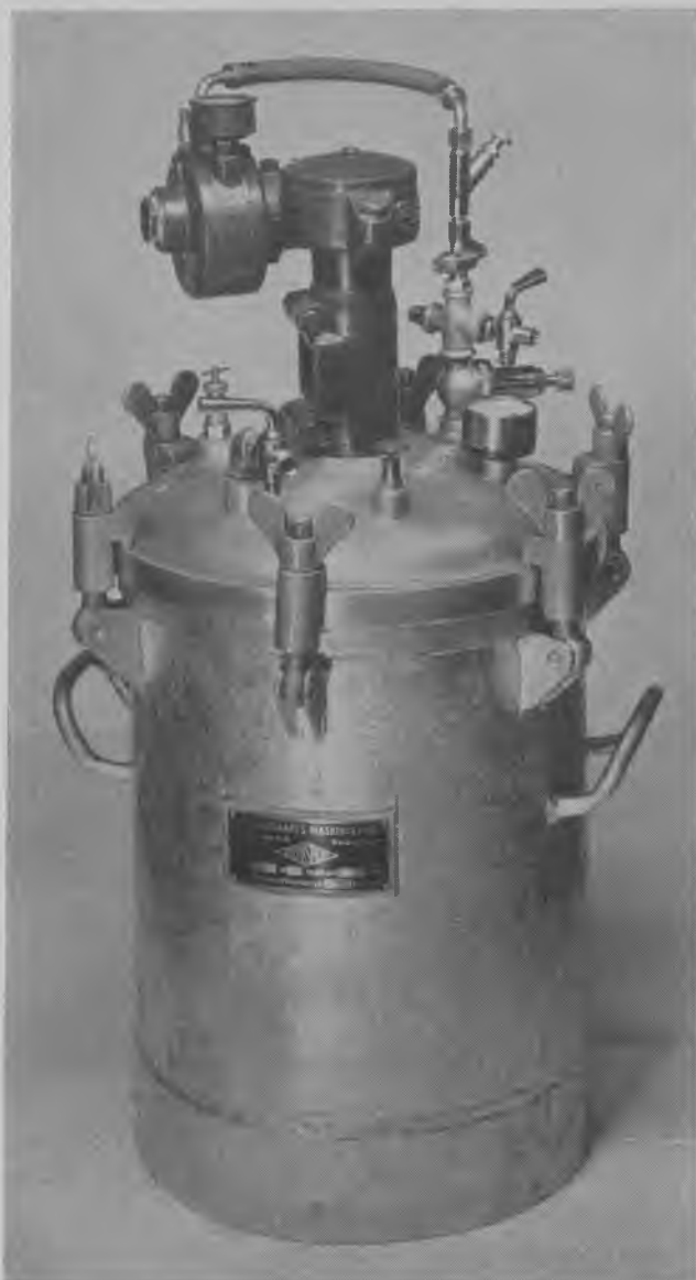
Fig. 616. Moderne trykfødebeholder med luftmører. Herfra trykkes lakken frem til sprøjtepipsten i den ønskede mængde, der angives i \text{cm}^3 pr. minut. Det ligger ved varmsprøjtning med cellulose omkring 450 \text{ cm}^3 pr. minut.
