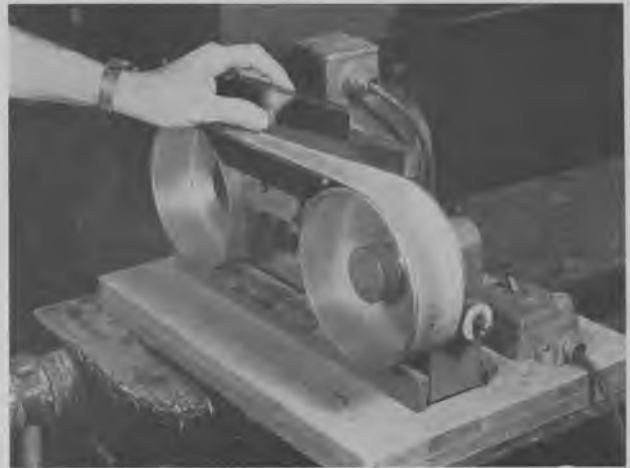
Fig. 626. Lille ziehklingeslibemaskine, der arbejder bånd i to finheder. Ziehklingen holdes som vist oven på slibe båndet, og ved hjælp af støttelisten køres frem og tilbage over båndet.
