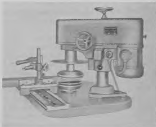
Fig. 255. Fræseapparat, kan anvendes separat eller i forbindelse med en underfræser til f. eks. tapfræsning.
