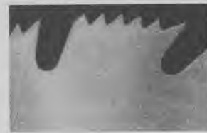
Fig. 124. Tandform på høvlsavklinger.
