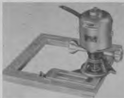
Fig. 327. Nedlægning af beslag med en håndoverfræser.
