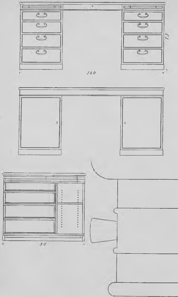
Fig. 539. Skrivebord med dobbelt front. Detail 1:1.
