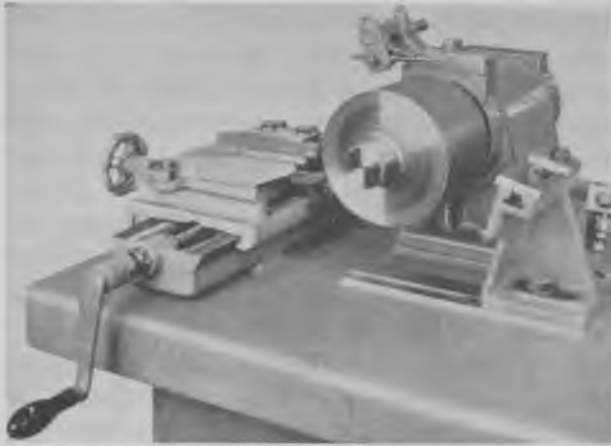
Fig. 187. Afretning af rundkutterjern.
