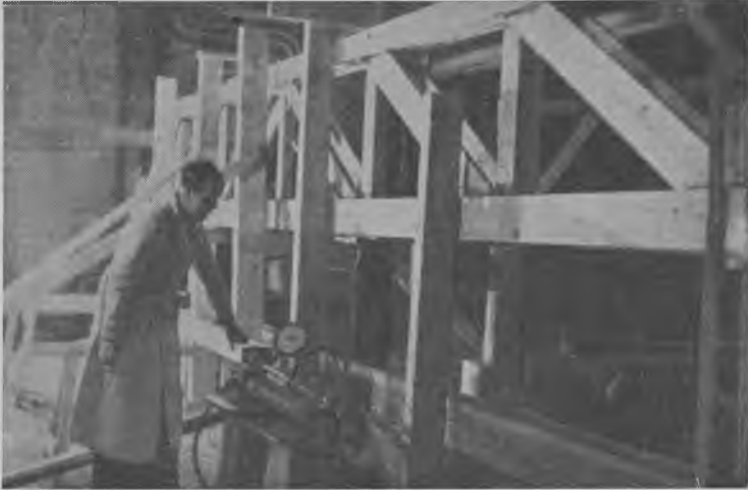
Fig. 583. Prøvetrykning af et fagværk i lamelkonstruktion, system ing. W. Berggren. Knudepunkterne højfrekvenslimet med resorcinollim (Cascosinol 1650).
