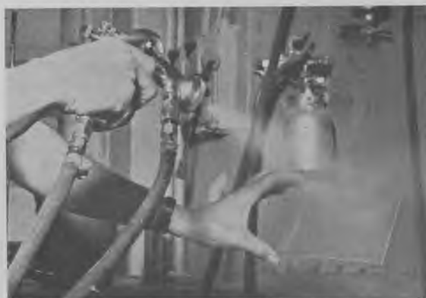
Fig. 632. Kontrolsprøjtning af klar lak på glasplade for at se, om lakmængde og forstøvningstryk er afstemt efter hinanden. En god kontrol på om der kommer »millionblærer« i lakken.
