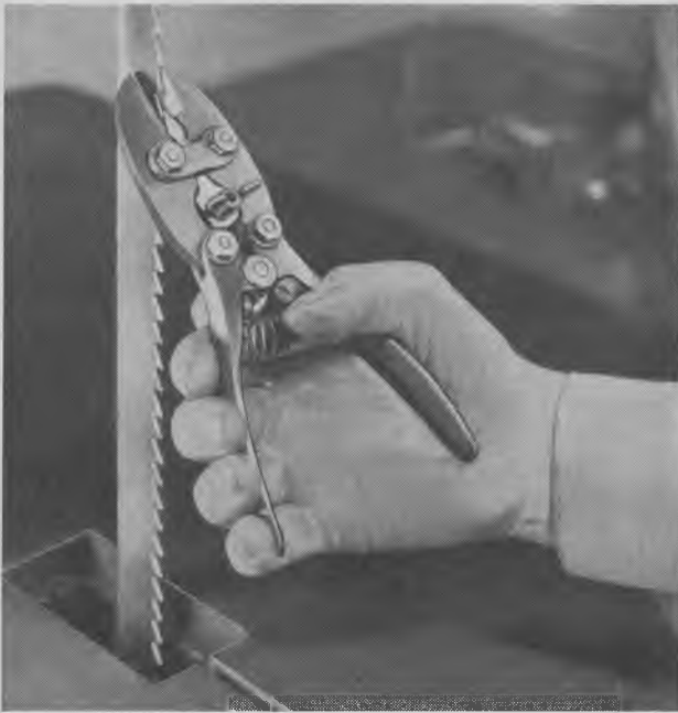
Fig. 142. Udlæggertang til båndsavklinger. Billedet viser den rigtige håndstilling ved udlægningen.
