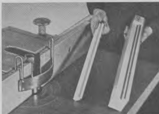
Fig. 241. Fræsning af sprosser i styrelist.
