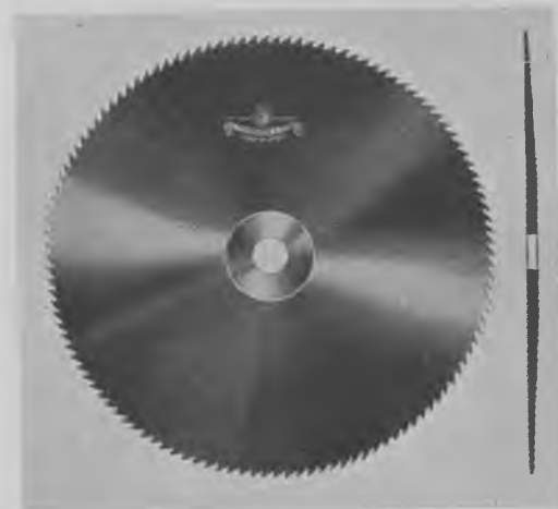
Fig. 125. Konisk rundsavklinge til højkantskæring af brædder og planker, hvis tykkelse ikke overstiger 2 tommer. Klingetykkelsen ved tandgangen er kun ca. 1 mm.
