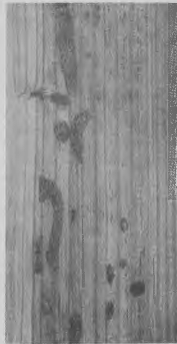
Fig. 23. Træhvepsens ( Sirex gigas ) gange.
