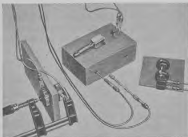
Fig. 43. Måling af træfugtighed med forskellige elektroder (Siemens).
