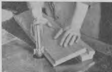
Fig. 254. Fræsning af fals. Forkert udført, lige emner fræses ved hjælp af anlæg. Trykfodnen mangler og knivene for stærkt udnyttet.
