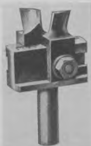
Fig. 230. Indstillelig gratfræser. Må ikke anvendes til højere omdrejningstal end 3000 omdr./min.
