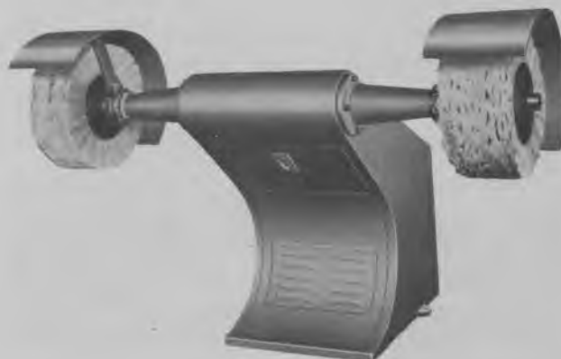
Fig. 630. En såkaldt Schwabbel-maskine, der bruges til fin polering af radiokabinetter. Til denne polering anvendes en speciel slibevoxs.
