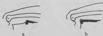
Fig. 559. a: Er stolesædet for højt og kort, trykkes lårmusklerne + kar og nerver. b: Er stolesædet for højt og langt, trykker det i knæhasen, hvor kar og nerver ligger lige under huden.
