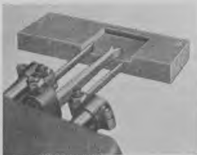
Fig. 298. Stemmemaskine med svingmejsel. Hullet udstemmes ved, at den i midten anbragte mejsel meget hurtigt bevæger sig frem og tilbage; samtidig renskæres hullets kanter af de to lockbeitler.
