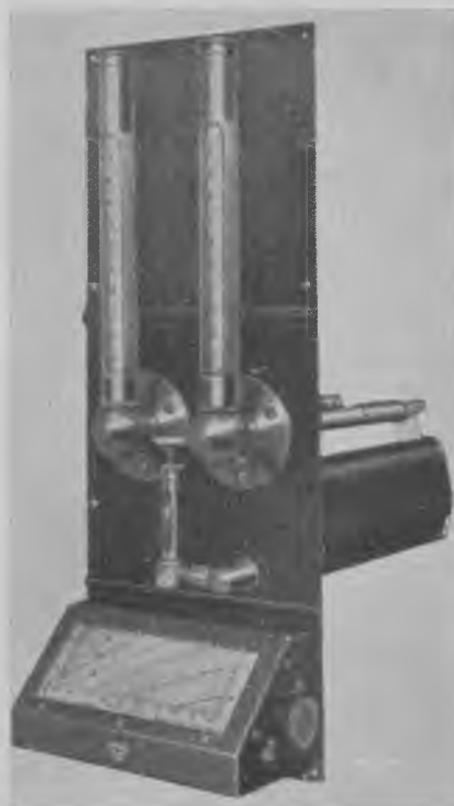
Fig. 49. Psykrometer for utilgængeligt rum.
