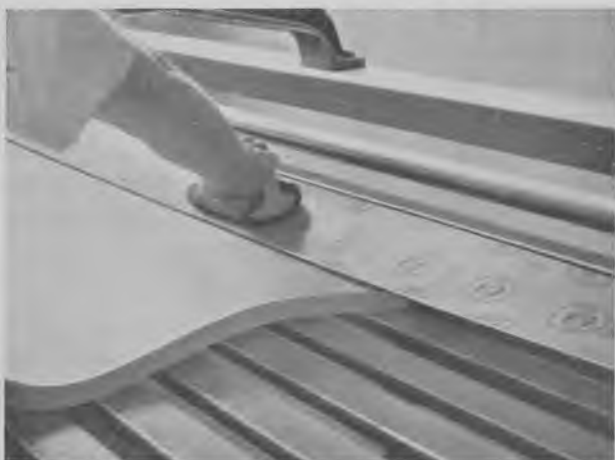
Fig. 598. Til pudsning af hvælvede emner er de flexible lærredsbånd at foretrække.
