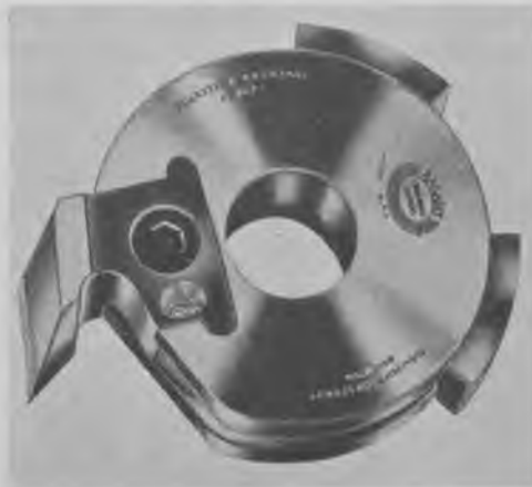
Fig. 229. Fræser med et jern. De to klodser til højre er forskydelige for afvejning. Fræseren bør kun anvendes til meget små partier.
