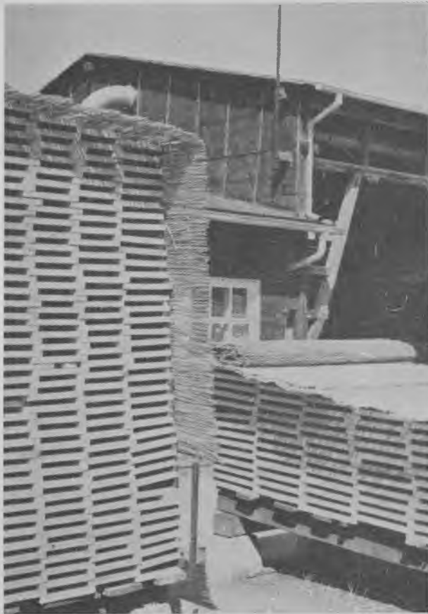
Fig. 65. Afdækning af stav med halm- eller sivmætter.
