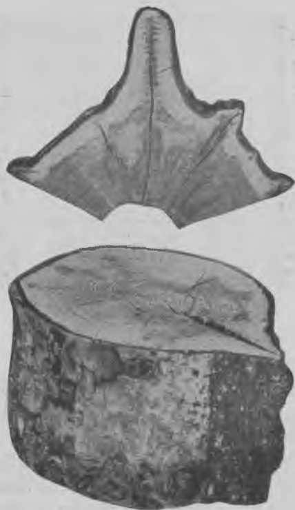
Fig. 13. Øverst: Overvokset frostrevner i eg. Nederst: Overvokset frostrevner i gran.
