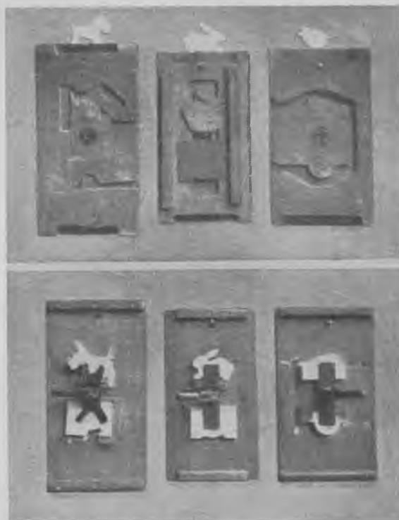
Fig. 272. Skabeloner korrekt udført, nemlig stort skabelonbræt, pålidelige spændehåndtag og styrelister. Negativet kan udskiftes med andre modeller. Er det større partier, der skal bearbejdes, betaler det sig at lave negativet i metal.
