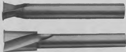
Fig. 225. Øverst: Konisk gratfræser. Nederst: Cylindrisk gratfræser.
