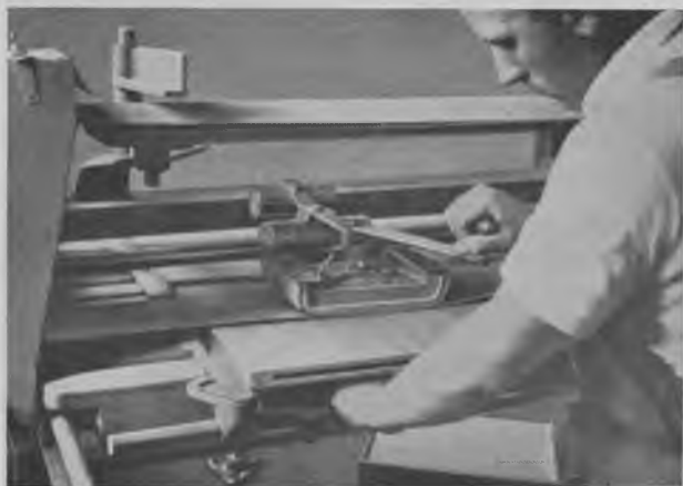
Fig. 597. Bemærk slibeskovens form med afrundede ender, det formindsker faren for gennempudsning ved kanterne.
