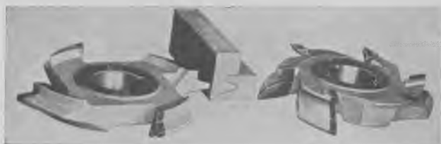
Fig. 177. Bagdrejede fræsekuttere til fræse- og kehlearbejder.
