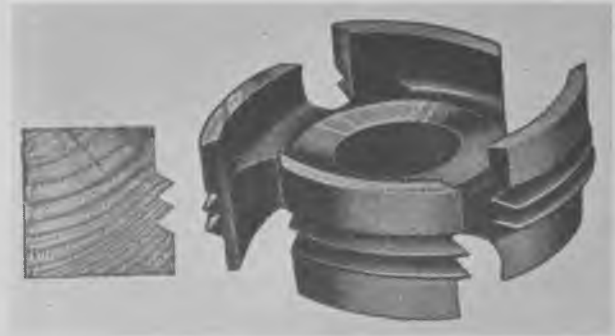
Fig. 232. Fræser til limfugning (bagdrejet).
