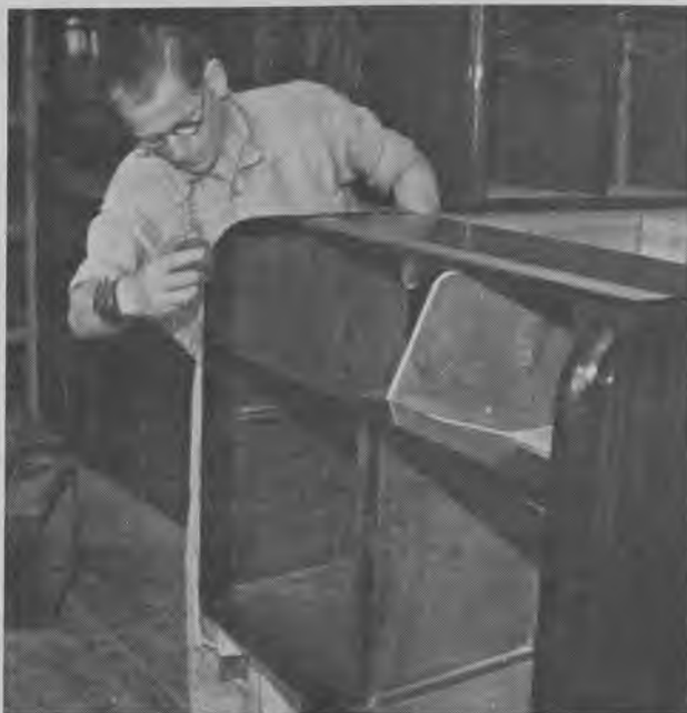
Fig. 628. Fordeling af lakken på profilerede kanter på et radioskab. Det skal foregå med let hånd, for at lakken ikke senere skal synke.
