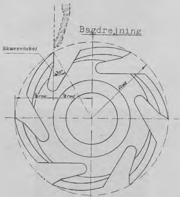
Fig. 236. Ved slibning af bagdrejede fræsere må kun slibes foran skæret, og således at den oprindelige skærevinkel, 30 grader, bibeholdes, i modsat fald ændres profilet. Der må ikke slibes på fræsersens profil, da den derved uvægerligt bliver ødelagt.
