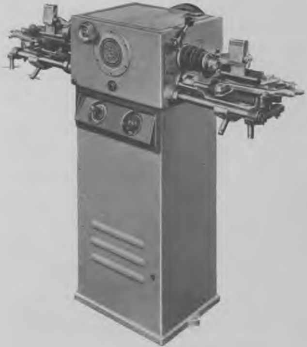
Fig. 627. Moderne ziehklingeslibemaskine for den lidt større industri. Giver en slibning, der ligger væsentlig over den bedste håndslibning.
