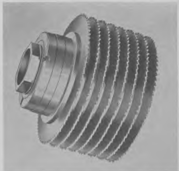
Fig. 209. Ved tilvirkning af blindtræ eller lignende er det fordelagtigt at anbringe rundsavklinger på stafkutteren. Sådanne klinger kan også anvendes på kehlmaskinen.
