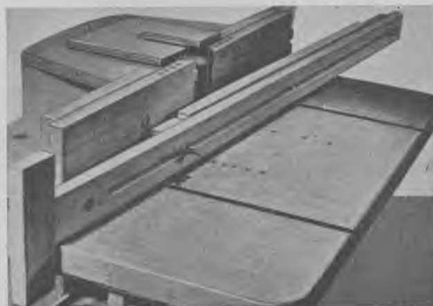
Fig. 242. Lære til indsats-fræsning.
