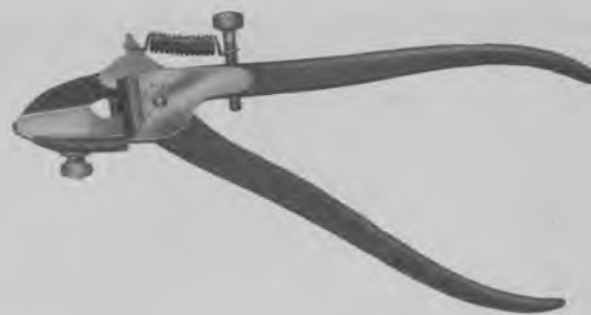
Fig. 139. Udlæggertang til båndsavklinger.
