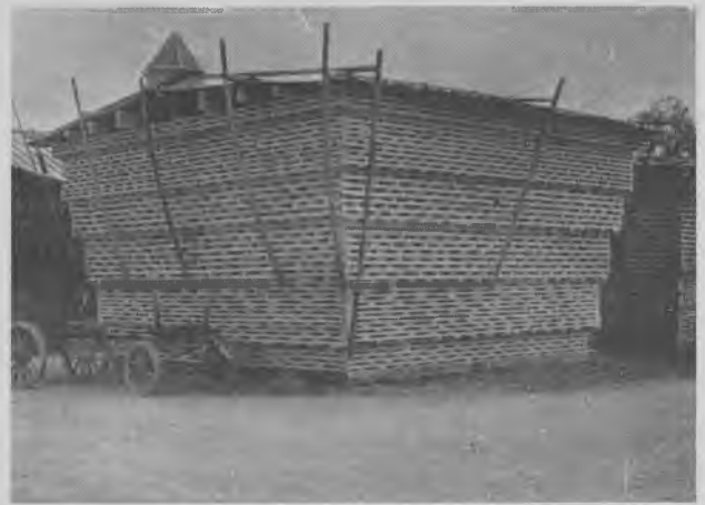
Fig. 67. Krydsstabling af brædder til lufttørring.
