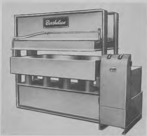
Fig. 590. Produktionsfinérpresse med automatisk tryk- og tidskontrol velegnet til urealim med kort afbindingstid.
