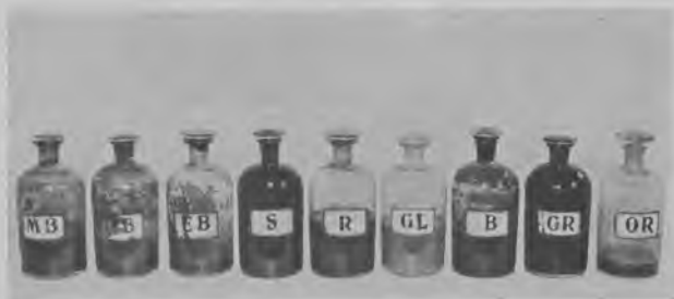
Fig. 600. En række stambejdsler, der er nødvendige at have, hvis man selv vil fremstille sine bejdsfarver.
