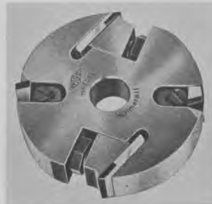
Fig. 233. Fræser med udskiftelige hårdmetalknive. Læg mærke til det påstemplede omdrejningstal n = 6000 , hvilket betyder, at det er det højeste omdrejningstal, som må anvendes til denne fræser.
