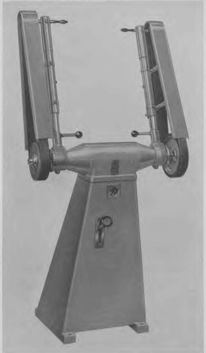
Fig. 317. Kontaktslibemaskine med kontinuerlig hastighedsregulering.
