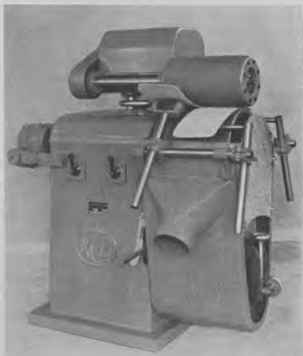
Fig. 322. Kurveslibemaskine. Maskinen er forsynet med en luftfyldt pudserulle og et bånd, der går over to skiver.
