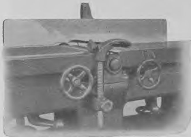
Fig. 194. Beskyttelsesskjold på en afretter.
