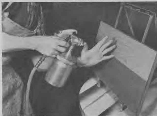
Fig. 619. Pistolens afstand fra overfladen skal være mellem 15–20 cm som en åben hånd.
