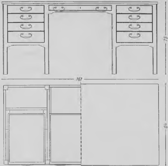
Fig. 543. Skrivebord med dobbelt front. Skurterne, der er 1,5 cm tykke, er skjulte. Kan udføres af afspærret eller massivt træ. Detail 1:1.
