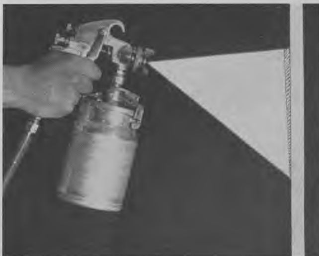
Fig. 621. Pistolen skal holdes vinkelret på overfladen, ellers får man påført uensartet lagtykkelse
